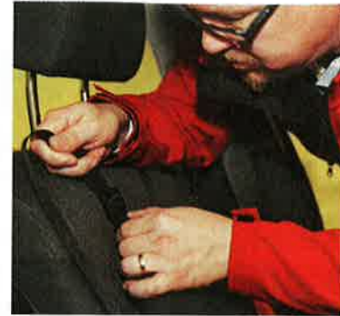
Istuin kiinnittyy auton istuimeen niskatuen ympärille kiinnitettävällä remmillä. Pitävä materiaali pitää istuimen paikoillaan.
