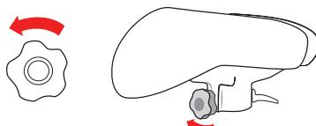
! Använd alltid knappen för att justera mellanrummet! Att justera sitsdelarna manuellt kan skada mekanismen.
