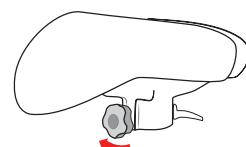
**! Tee säätö aina säätönuppia käyttämällä! Istuimen osien liikuttaminen käsin voi vahingoittaa mekanismia.**
