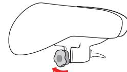
! Bruk alltid knotten for denne justeringen! Hvis du beveger setedelene manuelt, kan det skade mekanismen.
